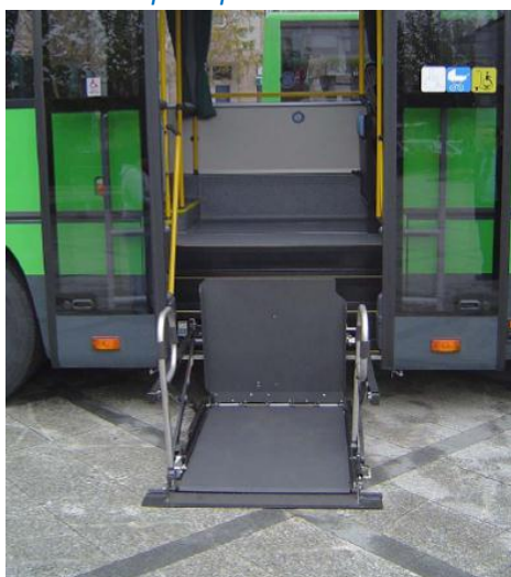
Rampa especial de acceso
